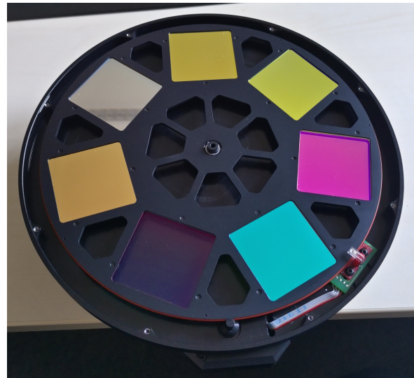
Abbildung 11.39: Das geöffnete Filterrad der C4-16000 mit den quadratischen 50 mm mal 50 mm großen Filtern, beginnend links unten gegen den Uhrzeigersinn: L, R, G, B, H \alpha , OIII, SII.
