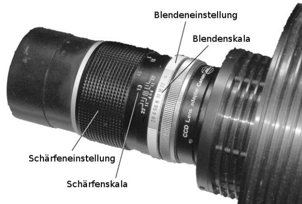
Abbildung 6.6: CCD-Kamera mit Objektiv und dessen Einstellringe für Schärfe und Blende.
