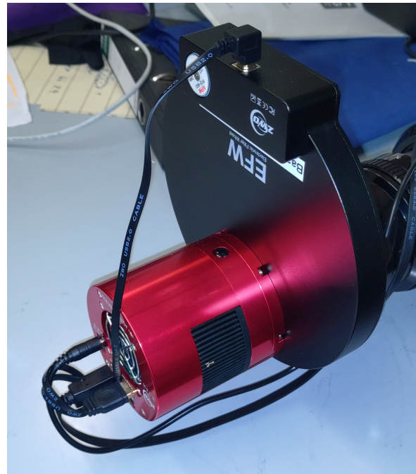
Abbildung 11.36: Die ZWO ASI6200MM Pro mit angebrachtem Filterrad und Verkabelung. Der gesamte Aufbau ist am Teleskop befestigt. Auf der Rückseite erkennt man den Lüfter und auf der Seite die Kühlrippen aus denen die Luft austritt.
