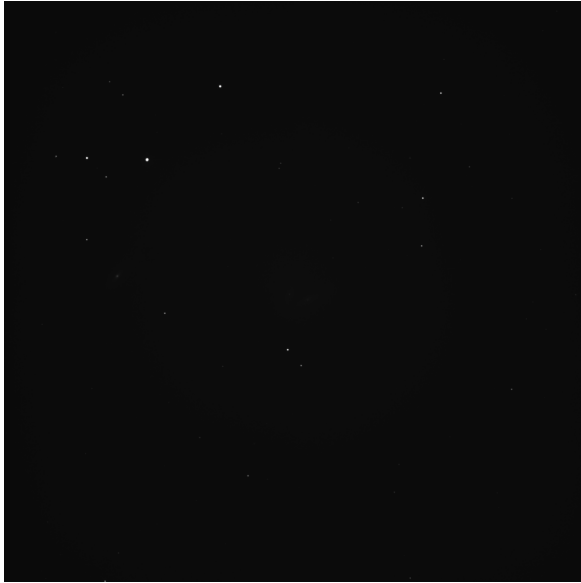
Abbildung 11.16: Lineare Darstellung einer Belichtung der Schmetterlingsgalaxien (NGC4567 & NGC4568) mit der C4-16000 am CDK20 und einer Belichtungszeit von 180 Sekunden. In dieser Abbildung sind nur einige Sterne erkennbar. Das Bild ist mit dem Luminanz-Filter bei einer Sensor Temperatur von -20^{\circ} aufgenommen worden.
