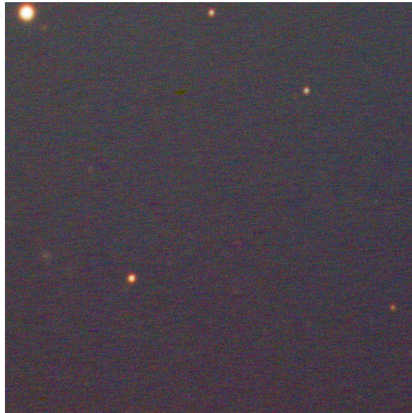
Abbildung 11.18: Farbige Walking Noise entstanden bei Aufnahme ohne Guiding und ohne Dithering am CDK20.
