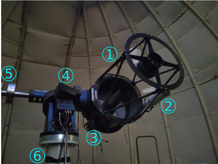
Abbildung 7.2: Das EHT mit den Komponenten: Teleskop (1), Guiding Teleskop (2), Steuerbox des Motorfokus (3), Montierung (4), Gegengewichte (5) und Säule (6). Im Hintergrund ist das Innere der Kuppel zu sehen.
